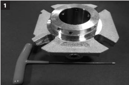
Utensili necessari per lo smontaggio della tenuta: Chiave a brugola (fornita con la tenuta); pinzette e punteruolo curvo (forniti dal cliente; per la rimozione degli O-ring e del tubo di azionamento).
