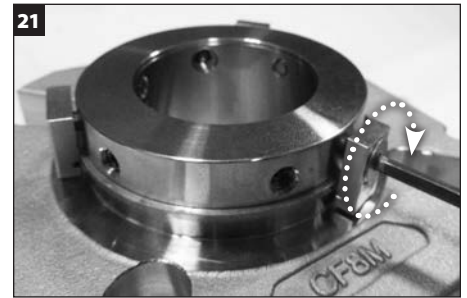
Installare i fermagli di centraggio sul diametro esterno dell'anello di blocco con le viti a testa cava esagonale incapsulata.
