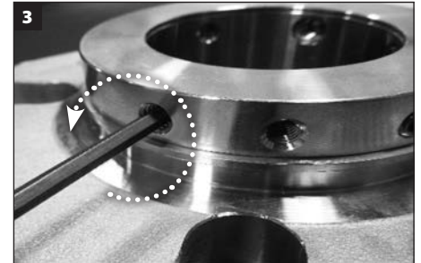
Rimuovere tutte le viti di fermo con estremità a coppa e cilindrica da 1/4 dall'anello di blocco ed eliminarle.
