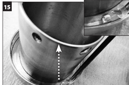
Rimuovere il tubo di azionamento dalle guide nella bussola ed eliminarlo.
